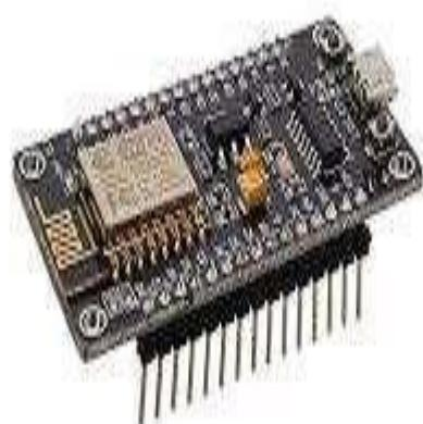
هو وحدة واي فاي (Wi-Fi) تم تطويرها بواسطة شركة Espressif System و تُستخدم هذه الوحدة بشكل واسع في تطبيقات أنترنэт الأشياء (IoT) نظراً لقدرتها على توفير اتصال ب شبكات الإنترنэт للأجهزة الالكترونية.
